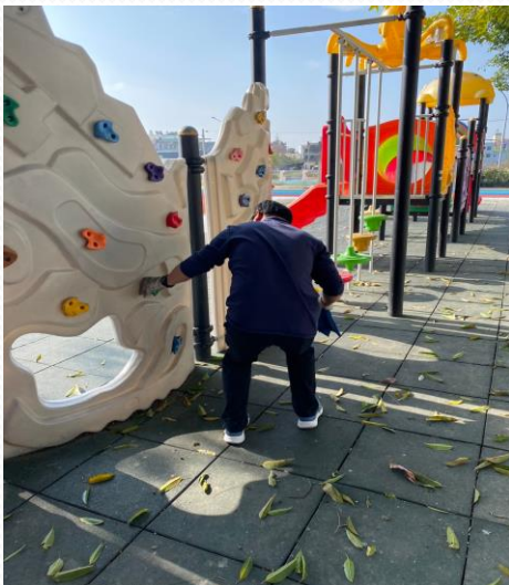
◎遊戲器材器材鏽蝕檢測
